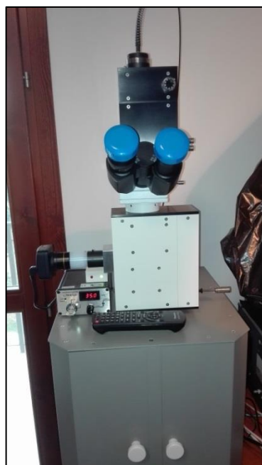
Figura 14. Spettrometro Raman utilizzato per le analisi sui campioni oggetto del tirocinio formativo. (di I. Rocchetti, Volta Mantovana).
